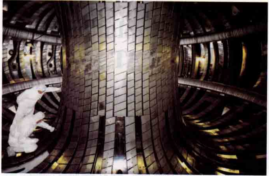
Termonükleer füzyon, yirmibirinci yüzyılın en önemli enerji kaynağı olmaya adaydır. Resimde, dünyanın en büyük deneysel füzyon makinesi olan JET (Joint European Torus)'in içi görülmektedir.
