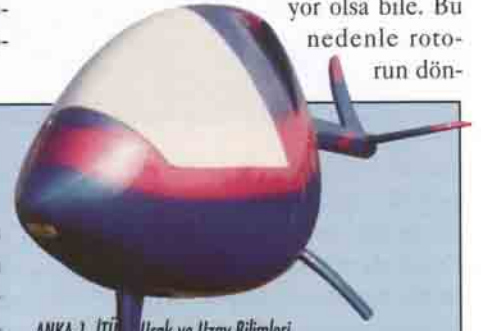
ANKA-1, İTÜ Uçak ve Uzay Bilimleri Fakültesinde tasarlanan 1-2 kişilik helikopter modeli.
