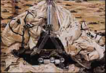
Yuvarlanma durduktan sonra, hava yastıkları sönmeye başlıyor. Bu işlem yaklaşık 1,5 saat sürüyor.
