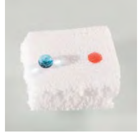
Su damlası (mavi) nanoselüloz süngerin yüzeyinde kalırken, yağ damlası (kırmızı) emiliyor.
