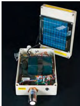
IFC portatif, güneş enerjili ve otomatik su seviyesi sensörü
