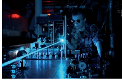
Referans kararlı lazer kullanılarak test lazerin dalga boyunun/frekansının tespit edilmesi
