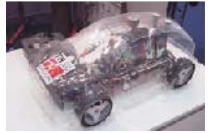
Yakıt pilleri, verimlilik ve temizlik bakımından, geleceğin enerji kaynağı olacak gibi görünüyor. Henüz daha çok deneme amaçlı olsa da bu araçlar yollarda görülmeye başlandı. Mercedes-Benz'in ürettiği yakıt pilli otomobiller ve otobüs gibi daha büyük başka araçlar tanıtım amacıyla çeşitli ülkelerde sergileniyor. Sağda: Yakıt pilli uzaktan kumandalı oyuncak otomobil. Yakıt pilleri, daha küçük uygulamalarda da gelecek vad ediyor.
