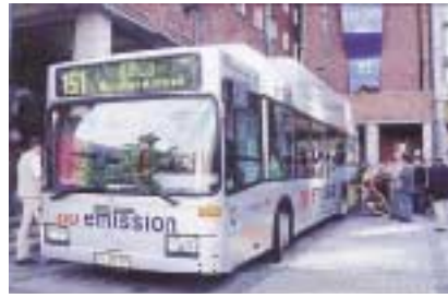
Yakıt pilleri, verimlilik ve temizlik bakımından, geleceğin enerji kaynağı olacak gibi görünüyor. Henüz daha çok deneme amaçlı olsa da bu araçlar yollarda görülmeye başlandı. Mercedes-Benz'in ürettiği yakıt pilli otomobiller ve otobüs gibi daha büyük başka araçlar tanıtım amacıyla çeşitli ülkelerde sergileniyor. Sağda: Yakıt pilli uzaktan kumandalı oyuncak otomobil. Yakıt pilleri, daha küçük uygulamalarda da gelecek vad ediyor.
