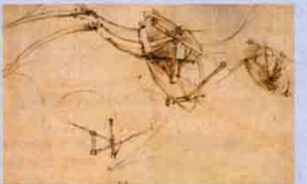
Kayık biçimlî bir gövdesi de olan küreklî bir ornitopter eskizi ve sonradan yapılmış kısmi modeli. Araca, yön ve yükseklik kontrolü sağlamak için kuyruk da eklenmiş. Günümüzdeki ornitopter tasarımlarında da, buradakinî benzer biçimde, kürek çekme hareketiyle uçuş ön planda
