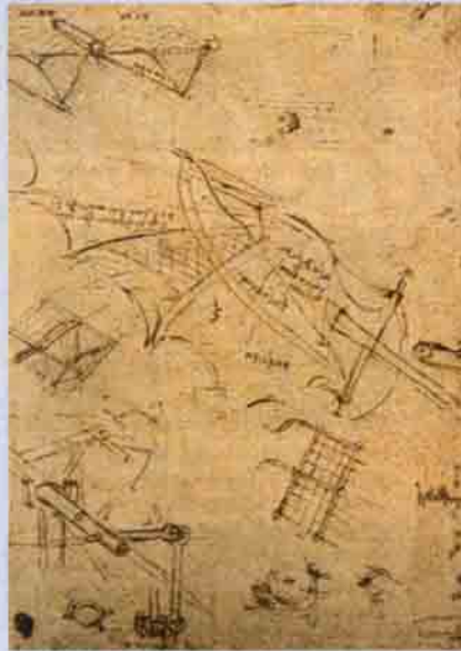
Bunlar büyük olasılıkla Leonardo'nun ilk kanat tasarımları. Hatalı olarak, kuşların kanatlarını yukarı çekişleri sırasında, tüylerin arasından hava geçtiğini düşünmüştü. Bundan yola çıkarak, kanatların yüzeyini, tek yönde açılır küçük kağıt kapakçıklarla dolu olarak tasarlanmıştır.
