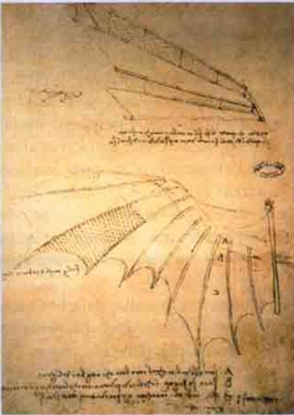
Bunlar büyük olasılıkla Leonardo'nun ilk kanat tasarımları. Hatalı olarak, kuşların kanatlarını yukarı çekişleri sırasında, tüylerin arasından hava geçtiğini düşünmüştü. Bundan yola çıkarak, kanatların yüzeyini, tek yönde açılır küçük kağıt kapakçıklarla dolu olarak tasarlanmıştır.
