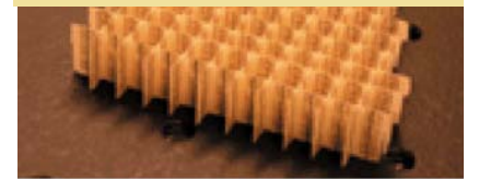
Şekil 3: UCSD’deki grubun negatif kırılmayı gözlemlediği metamalzeme. Burada kesik halkalı rezonatörler ve onların arkasına yerleştirilmiş bakır teller, malzemenin mikrodalgalarla karşı negatif kırılma indisi göstermesini sağlıyor. Burada rezonatörler ve teller fiberklas bir devre kartı üzerine basılmış.
