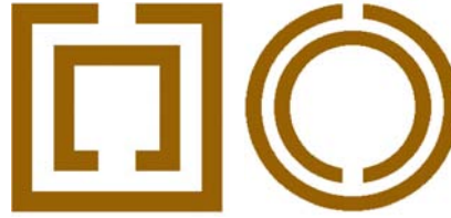
Şekil 2: İki farklı geometrideki kesik halkalı rezonatörler
