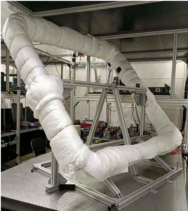
2 kilometre uzunluğunda fiber optik kablonun yaklaşık 2 metre kare alüminyum çerçeve etrafına dolanmasıyla üretilen Sagnac girişimölçeri. Cihazı çevreleyen yalıtım malzemesi, sıcaklık salınımlarının ve hava akıntılarının ölçümler üzerindeki olumsuz etkilerini azaltıyor.
