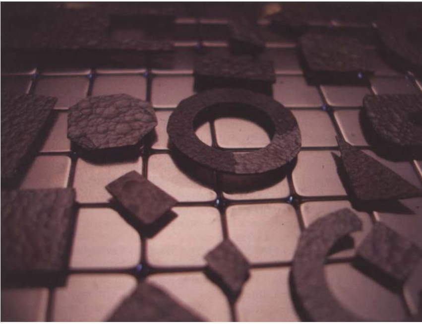
Çeşitli şekillerde kesilmiş pirolitik grafit parçalar ilginç bir şekilde havada duruyor. Bu resimdeki düzenekte, kalıcı bir mıknatısın üzerinde asılı 120 cisim var. Aktif geribildirimli kullanarak aynı cisimleri havaya kaldıracak ve dışardan verilen güçle çalışacak bir aygıt, tasarım ve üretim açısından önemli bir mühendislik girişimi olurdu. Buradaki basit, pasif diamanyetik yükselme sistemiye bu işi daha kolay yapar.
