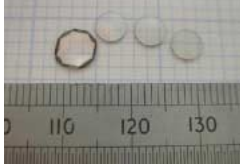
Elmas yarıiletkenler, “karbon elektronığı” çağını açmaya aday.
