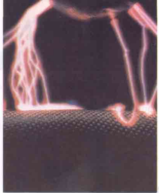
İletken plastik tarafından yapay yıldırımların soğurulması: Lockheed firması "plastik uçak" üzerinde çalışıyor.
