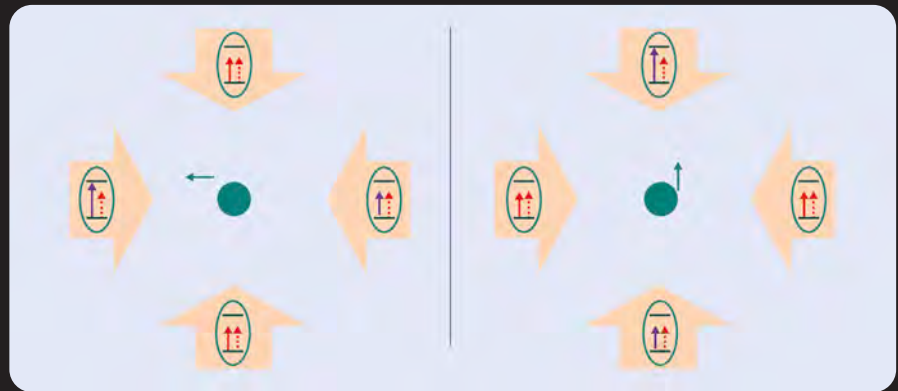
Optik ağdalarla birbirine dik olarak konumlandırılmış üç çift lazer bulunur. Atomlar hangi yönde hareket ederlerse etsinler soğutucu bir lazerle etkileşebilirler.
