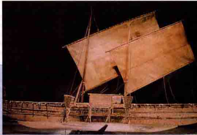
Şekil 2: Para-Mikronezya açıkdeniz yelkenlisi. Kabasortu armalı olup uzaklıklar için düzenlenmiş bu tekneler eli mürettebat ile yola çıkabiliyordu. Bu resimde görülen tekne, tipinin son örneği ve 1904 yılında Berlin'e getirildi. Tamı boyu 15 metre civarındadır. (Museum für Völkerkunde, Staatliche Museen zu Berlin, Preussische Kulturbesitz)
