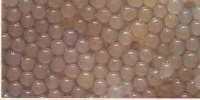
Şekil 4. Ca-alijmatta tutulmuş Zoogloea ramigera partikülleri
