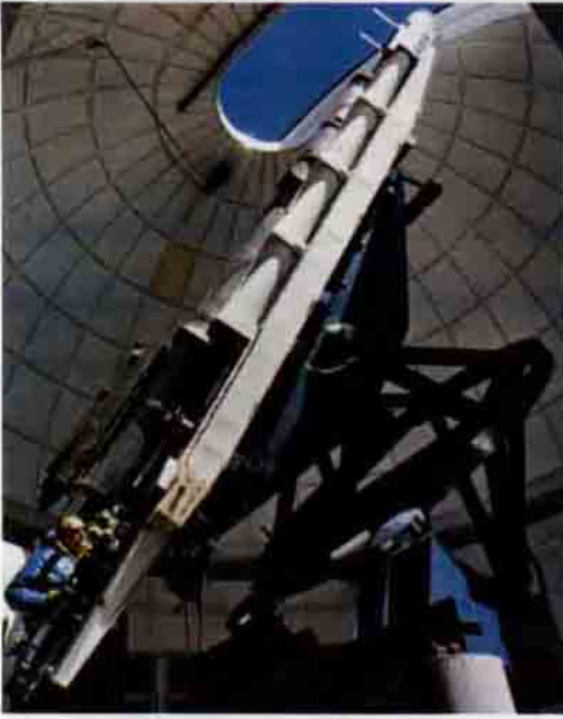
Gökbilimciler (Astronomlar), Güneş'i incelemek için karmaşık aygıtlar yaptılar. Pic du Midi Gözlemevi'nin Bailland Kubbesi'nde, bir güneş bataryası ile donatılmış ekvatora paralel bir tabla vardır.
