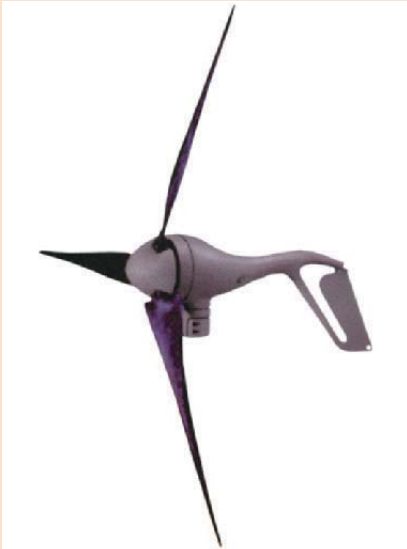
Şekil 2: Bu model, rüzgar hızı 10 km/saat iken çalışmaya başlıyor ve 40 km/saat'te, 400 W'lık tasarım gücüne ulaşıyor. 12 veya 24VDC gerilim üretiyor ve şarj denetleyicisine sahip. Denetleyicinin gelişkin kontrol devreleri; yüksek rüzgar hızlarında rotor palalarının açısını değiştirmek suretiyle dönme hızını düşürüyor ve böylece, hem sarsıntıları ve gövde üzerindeki aşırı yükleri önleyip, hem de gürültüyü azaltıyor. Aküyü şarj işlevini de, voltajını devamlı yoklayarak, kontrollü bir şekilde yerine getiriyor. Fiyatı 600 ABD doları kadar.
