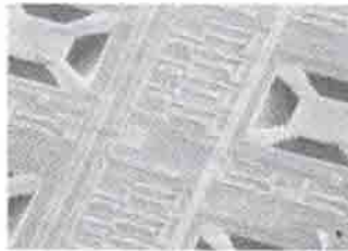
Pul çapında tümlleşik bir transducer dizini devresinin çok yakından görünüşü.
