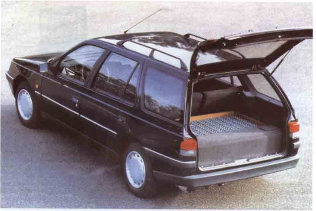
Peugeot'nun bu Break 405'i, bir yıl önce PSA tarafından sergilenmiş olan ilk elektrikli uzun yol arabası prototipidir. Arka bölümündeki 200 kiloluk akülerle hiç durmaksızın 750 kilometre yol gidebilir. Bu, aküleri otomatik olarak şarj eden bir dizel motoru sayesinde sağlanmaktadır.
