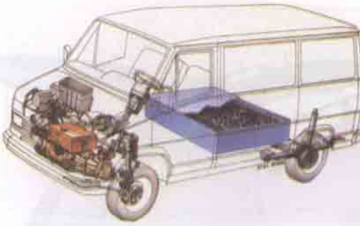
Peugeot ve Citroen'in J5 ile C15 furgonelleri, iki yıldan beri elektrikli olarak da yapılmaktadır. Motor, fiyatını ucuz tutmak için aynen klâsik bir termik motorun yerine takılabilecek biçimde tasarlanmıştır (soldaki çizime bakınız).
