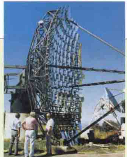
Whipple Gözlemevi'nde bulunan elektronik kameranın ışık toplayıcı aynaları.
