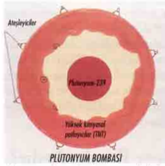
PLUTONYUM BOMBASI Plutonyumun küresel merkezi çevresinde bulunan kimyasal patlayıcılar aynı anda patlarlar.
