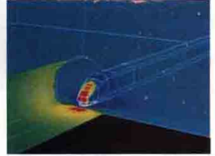
Tren tünele girdiğinde, yolcuların kulaklarında uğultuya neden olan basınç dalgaları, tünel boyunca trenle birlikte ilerler ve geri döner. Bazı dalgalar bilgisayar simülasyonu ile ölçülebilir; kırmızı renk en yüksek basıncı gösterirken, onu yeşil ve sarı izler. Simülasyon sonuçları, trenlerin burun kısmının uzun olmasının basınç dalgalarını azaltıcı bir etki yaptığını gösterir.
