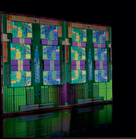
Birbirine paralel çalışan 6 çekirdekli mikroçip AMD Opteron
