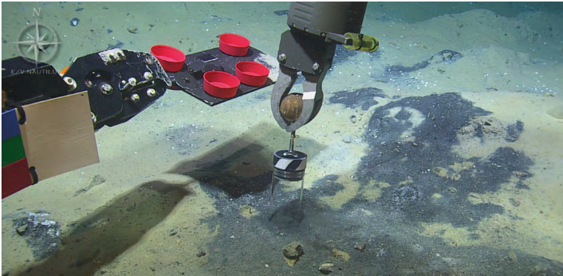
Şekil 4. Biyolojik analiz ve çökelti analizi için mikrobik tabanların ROV tarafından örneklenmesi (çekirdek örnekleri)
