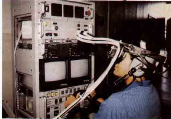
Teleoperatör jip: Uzaktan yönetilen bu savaş aracı, çok tehlikeli bölgelerde insansız olarak kullanılabilir. Jipe uzaktaki bir yerde komuta eden operatör, araç üzerindeki iki kameranın tespit ettiği görüntüleri, özel bir başlığa yerleştirilmiş iki ekrandan izleyebiliyor.
