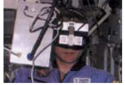
Mir Uzay İstasyonu'nda gerçekleştirilen bir deneyde kozmonot Sergey Avdeev, üzerinde LED'ler bulunan bir maske takıyor. Bir silikon dedektör de görüş alanında ışık parlamalarına yol açan parçacıkları izliyor.
