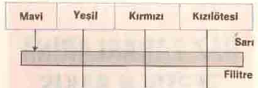
Kızılötesi - renkli film'in yapısı.
