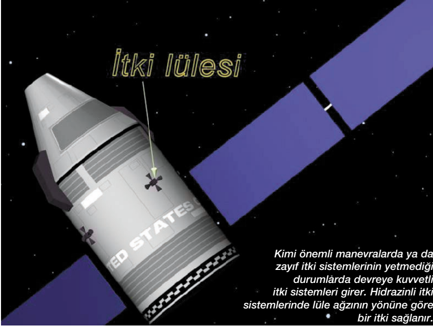
Durum kontrol sistemlerinin montajı bitmiş bir uydun gövdesi
