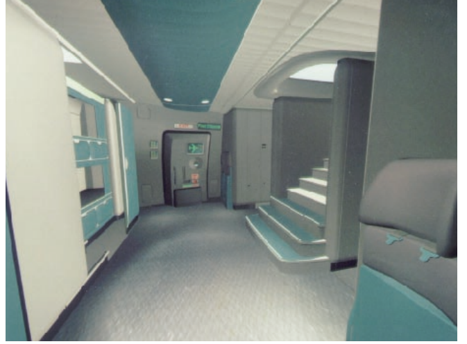
Airbus A3XX'in bilgisayarda üretilmiş canlandırmalarından biri. Ekonomi sınıfı bir yolcu kabinine ait genel bir görüntü (solda). Airbus A3XX'in ana kapıları, yolcuları üst ve alt kat kabinlerine bağlantıları olan geniş bir giriş bölümüne ulaştıracak (sağda).
