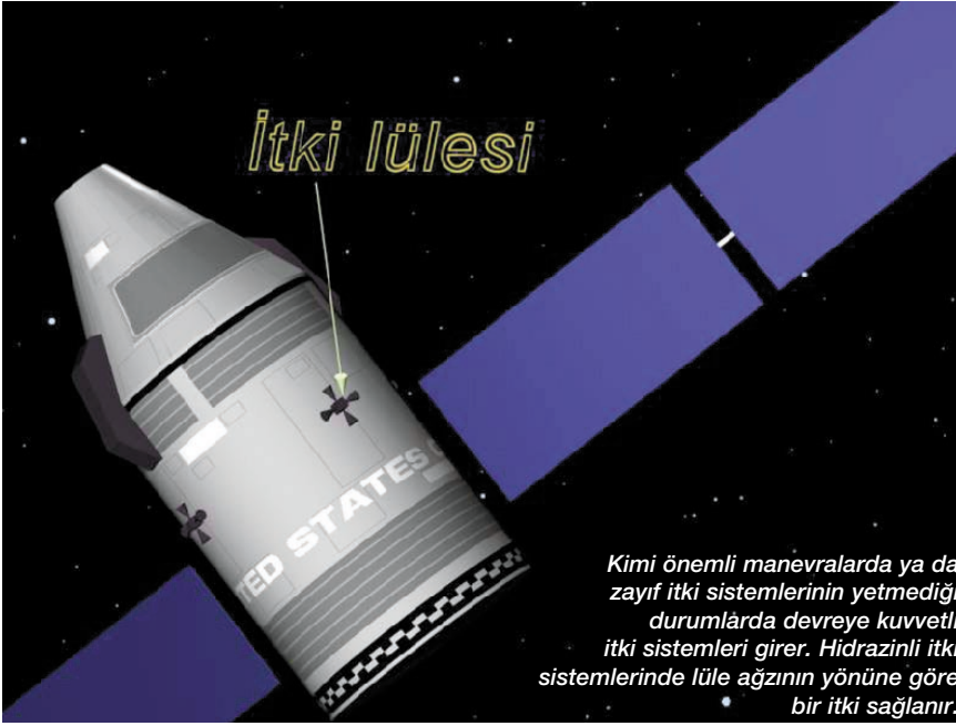
Durum kontrol sistemlerinin montajı bitmiş bir uydunun gövdesi
