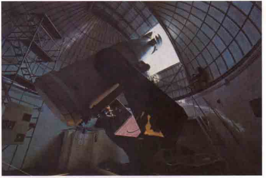
Cerga gözlemevinin 1,5 metre çaplı Schmidt teleskobu.
