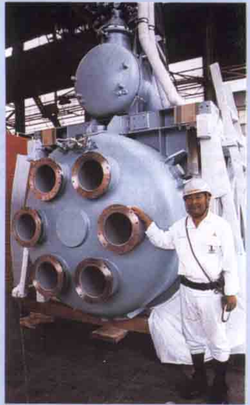
Geminin jet teşkilatı: MDH motorlarının her biri 6 tane jet borusuna sahip; borulardan fışkırtılan su ışıını demetleri sayesinde gemiyi harekete geçirecek bir itme gücü oluşturuyor.
