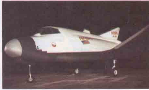
Bu model uzay uçağı, mekiğin 1/10 ağırlığında olmasına rağmen, iki mürettebat ve sekiz yolcu taşıyabilecek şekilde tasarlanmıştır.
