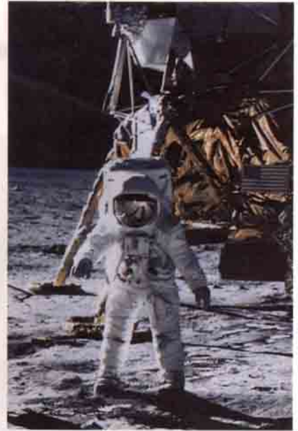
Çok iyi bir iletken olan altın, bazı elektronik devrelerde ve UV ışınlarını iyi yansıtılabildiği için de uzay elbiseleri başlıklarında kullanılır. Uzay araçlarında da altın kullanımı yaygındır. Kızılötesi ışınları iyi yansıtılabildiği için altından büyük binaların ısı yalıtımlı camlarında yararlanılır.
