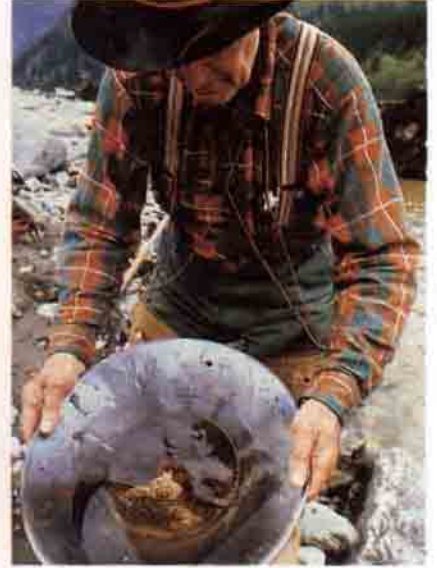
Bir kayaktan elde edilmiş altının cevher hali (solda). Alüvyonlu çökellerden plaser madenciliği yöntemiyle altın elde edilmesi (sağda).
