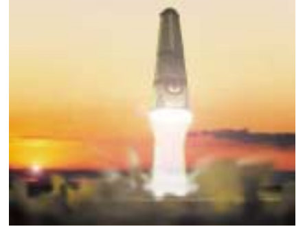
Rotary Roket Şirketi'nin uzay aracı Roton, tıpkı klasik bir roket gibi fırlatılıyor. Dünya yörüngesine ulaşıp, yükünü bıraktıktan sonra hızla atmosfere giriyor. Yere inerken aracın önündeki büyük pervaneler açılıyor ve araç tıpkı bir helikopter gibi iniyor.
