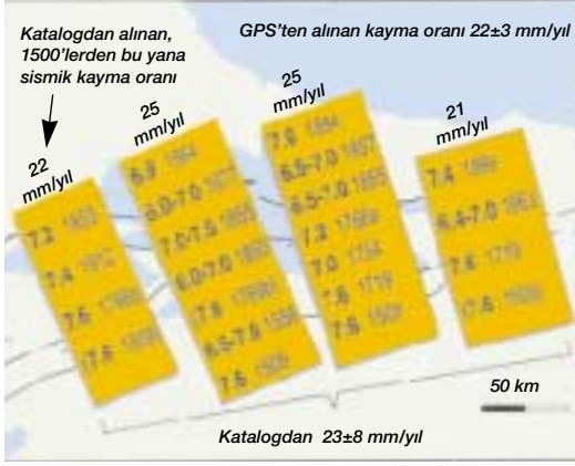
Şekil 3. 500 yıllık kataloga bağlı olarak yapılan Şekil 2'den elde edilen sismik kaymalar, Marmara Denizi ve yakınındaki Kuzey Anadolu Fay sistemine dik alınan dört kesitte özetlenmiştir. Büyükliğünün yaklaşık 7 ve üzerinde olduğu aletsel verilerle kesin bilinen ya da böyle olduğu hesaplanan bütün tarihsel depremler kullanılmıştır. Ortalama sismik enerji, açığa çıkma oranı GPS verilerinden elde edilen enerji birikimini dengelemektedir. Parantez içinde verilen depremlerin verilen kesitlere kadar uzanıp uzanmadığı tam olarak belli değildir (1766a Mayıs; 1766b Ağustos).
