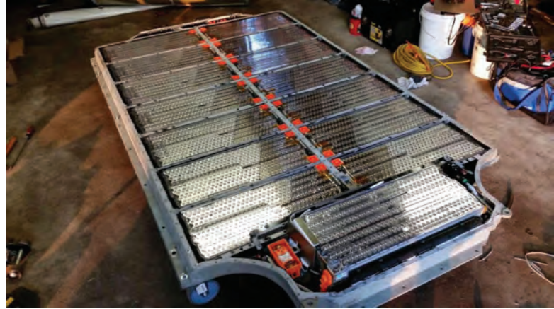
Tesla'nın binlerce pilden oluşan elektrikli otomobil bataryası
