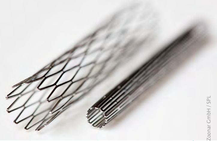
Stentin farklı sıcaklıklarda şekil değiştirmesi
