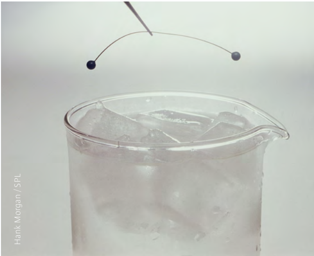
Nitinol telin farklı sıcaklıklarda şekil değiştirmesi
