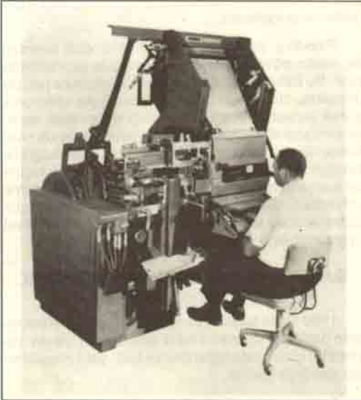
Linotipi makinesinde operatör, klavye yardımıyla harfleri belirli satır uzunluklarında dizer. Dizilen satır, daha sonra tek parça halinde erimiş kurşundan dökülür.
