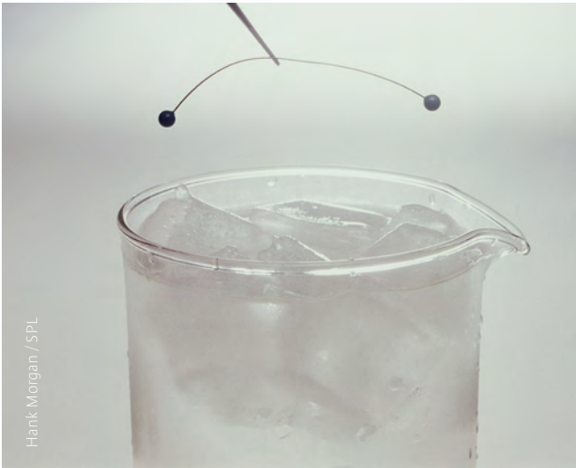
Nitinol telin farklı sıcaklıklarda şekil değiştirmesi
