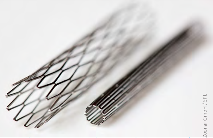
Stentin farklı sıcaklıklarda şekil değiştirmesi
