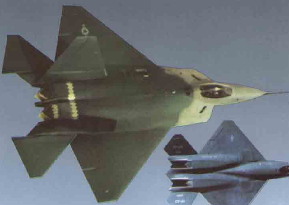
Hareketli lüle, YF-22'nin kanat düzenleri arasında görülmektedir. Lüle, iyi bir radar kamuflesi yapabilmek amacıyla yassı olarak dizayn edilmiştir.
