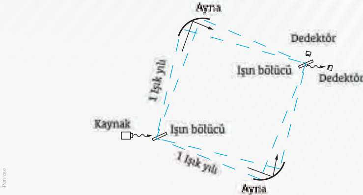
Şekil 4.4: Kozmik ölçekte bir Mach-Zehnder girişimölçeri. İlk ışın bölücüde dalga fonksiyonu iki parçaya ayrılır. Bu parçalar aynalardan yansıyıp ikinci ışın bölücüden geçtikten sonra girişim yapar. Fotonlar iki dedektörün sadece birinde kaydedilir.
