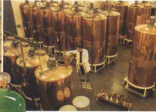
uçucu yağların eldesinde baş vurulan damıtma işlemi, bu devasa aletlerin yardımıyla yapılmaktadır.
