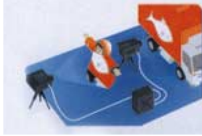
Günümüzde Görünmezlik: Susumi Tachi'nin pelerinde, yağmurluğu giyen kişinin sırtındaki bir kamera, kullanıcının arkasındaki görüntüleri bilgisayar yardımıyla bir projektöre aktarıyor. Projektör, bu görüntüleri tıpkı sinema perdesine yansıtır gibi yağmurluğa yansıtıyor. Yağmurluğu giyen kişi, tuhaf bir biçimde saydam oluyor: elbette, izleyiciler projektörün hizasındaysa ve arkaplan çok parlak değilse.
