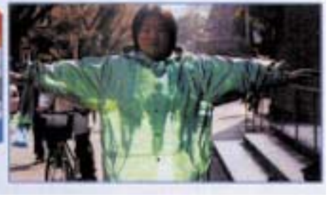
Günümüzde Görünmezlik: Susumi Tachi'nin pelerinde, yağmurluğu giyen kişinin sırtındaki bir kamera, kullanıcının arkasındaki görüntüleri bilgisayar yardımıyla bir projektöre aktarıyor. Projektör, bu görüntüleri tıpkı sinema perdesine yansıtır gibi yağmurluğa yansıtıyor. Yağmurluğu giyen kişi, tuhaf bir biçimde saydam oluyor: elbette, izleyiciler projektörün hizasındaysa ve arkaplan çok parlak değilse.
