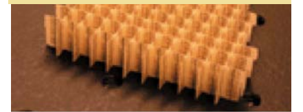
Şekil 3: UCSD’deki grubun negatif kırılmayı gözlemlediği metamatizme. Burada kesik halkalı rezonatörler ve onların arkasına yerleştirilmiş bakır teller, malzemenin mikrodalgalara karşı negatif kırılma indisi göstermesini sağlıyor. Burada rezonatörler ve teller fiberklas bir devre kartı üzerine basılmış.
