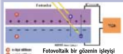
Fotovoltaik bir gözünün işleyişi
