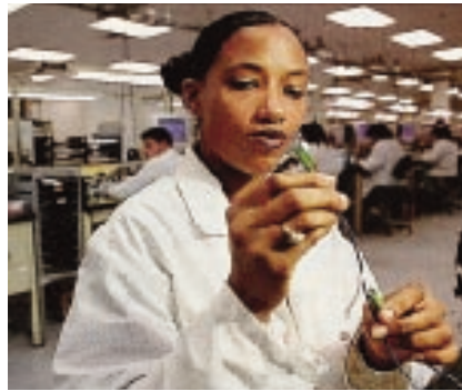
Çoklayıcı yapımı: Ciena şirketinde uzaktan iletişim için gerekli optik bileşenler monte ediliyor.
