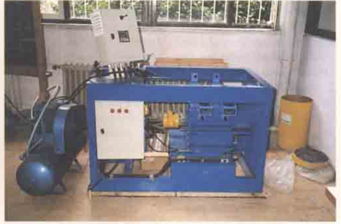
Büyük boylu kesme deney aleti (TUBITAK INTAG 627)
