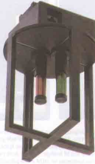
Radio aktarıcılar, elektronik tabloları ve diğer hareketli bilgisayar birimlerini kablolu şebekeye bağlıyor. Tavana monte edilen bu cihaz, iki çapraz anten kola ve durumunu gösteren iki ışıklı diyota sahip.
