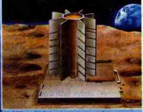
ALSEP (ABD'nin Ay istasyonu), 70 W'lık SNAP 27 üreteci ile donatılmıştır.
