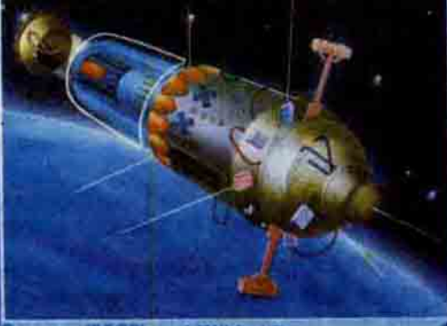
Cosmos (SSCB), 1 kW'lık "Romachka" reaktörü ile, 1977'den sonra ise 10 kW'lık "Tupaze" reaktörü ile donatılmıştır.
