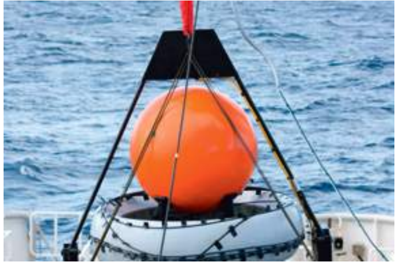
Hidroakustik görüntülemeye akustik sinyallerin algılanmasında kullanılan hidrofon isimli ekipman
