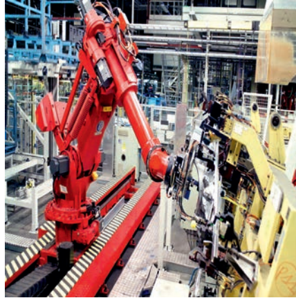
6-eksenli eklemlili robot (Comau)
