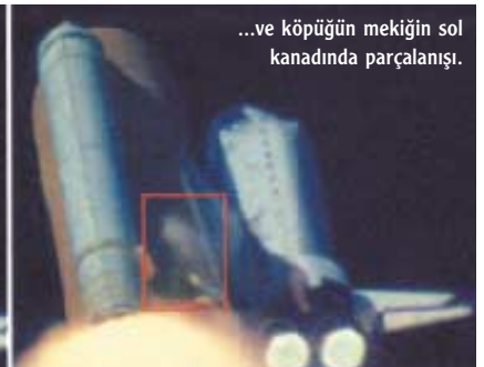
Columbia'nın fırlatılış sırasında yakıt tankından kopan yalıtım köpük...
