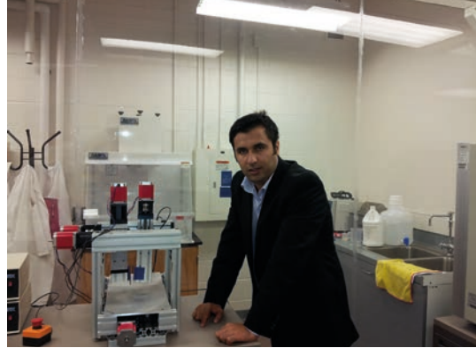
Dr. Özbolat'ın Biyo-üretim laboratuvarında geliştirilmekte olan çift kollu prototipleme robotu, aynı anda hem damar dokuyu hem de pankreas hücrelerinden oluşan ve insülin salgılayan dokuyu prototiplemek üzere tasarlandı.
