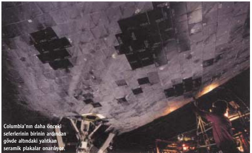
Columbia'nın fırlatılış sırasında yakıt tankından kopan yalıtım köpük...
